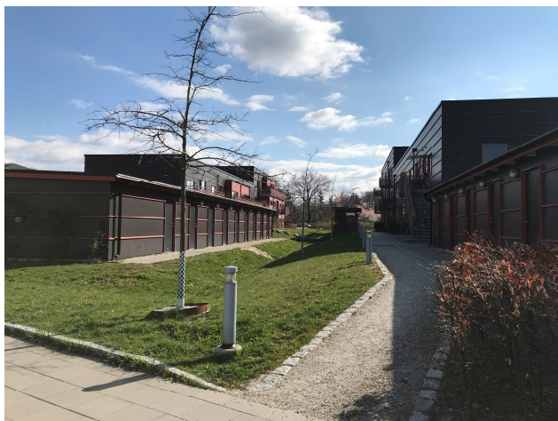
Bild 3: Gräsyta som vatten leds ytligt över till svackdike för infiltration. (Malmö/Pernilla Rudin)
